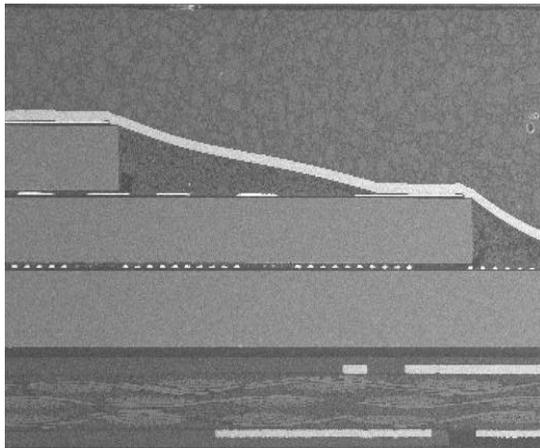
**Figure 4. Aerosol Jet Printed Die to Die Interconnects**
